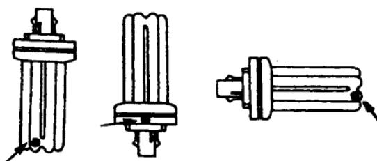
Рис. 16. Изменение позиции "холодной" точки ламп Biах при различных положениях эксплуатации
