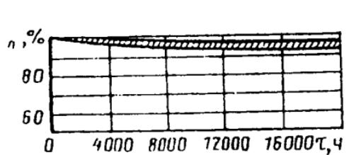
Рис. 4. Изменение светового потока ЛЛ диаметром 16 мм (серия TL'5 HE, Philips Lighting) в процессе эксплуатации
