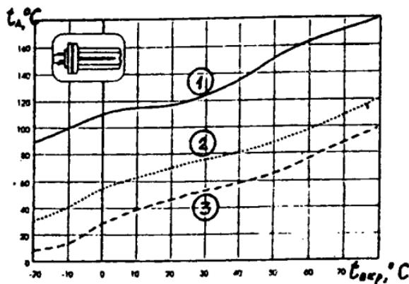
Рис. 17. Зависимость температуры в контрольных точках 6-канальных ламп Вiax T/E 18 Вт от окружающей температуры при различных положениях эксплуатации:
