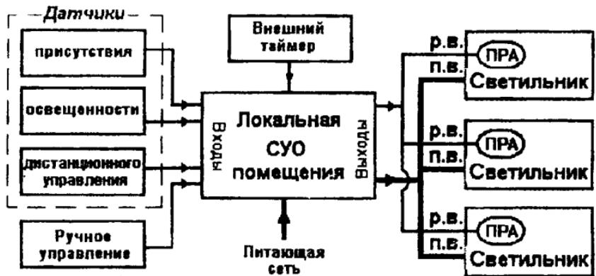
Рис. 4. Обобщенная принципиальная схема СУО помещения:
