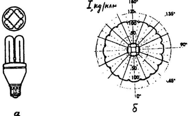
Рис. 33. Восьмиканальная амальгамная КЛЛ типа QBX мощностью 23 Вт фирмы GE-Lighting:
