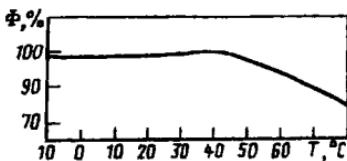
Рис. 6. Зависимость светового потока БИЛ типа Genura от температуры окружающего воздуха
