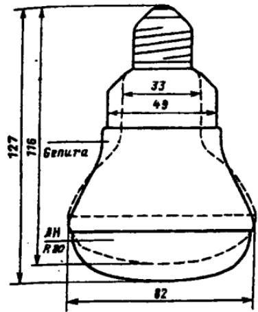
Рис. 4. Общий вид БИЛ типа Genura и сравнение ее габаритов с зеркальной ЛН R80 (100 Вт)
