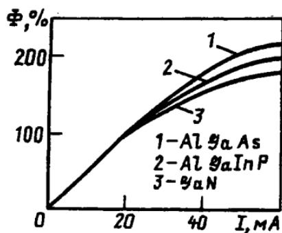
Рис. 3. Зависимость потока, излучаемого светодиодами, от тока
