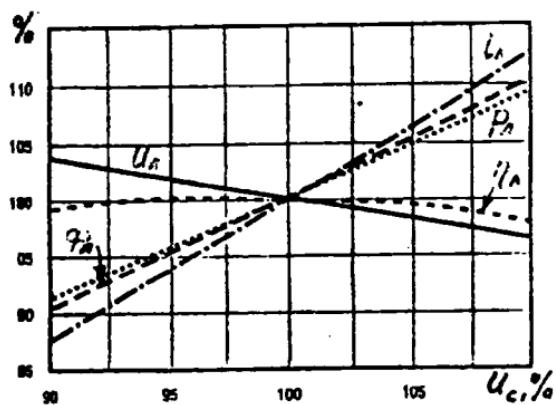
Рис. 23. Типовые зависимости электрических и светотехнических параметров КЛЛ от напряжения сети (данные фирмы Osram)
