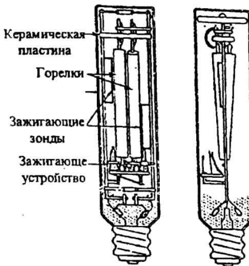
Рис. 5. НЛВД со встроенным зажигающим устройством
