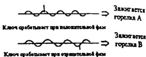
Рис. 7. Распределение зажигающих импульсов
