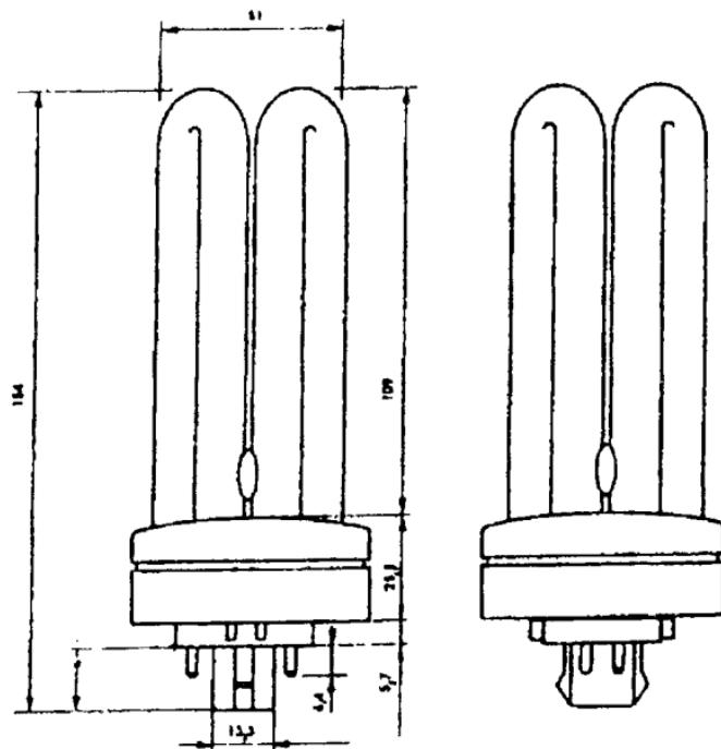
Рис. 30. Восьмиканальная амальгамная КЛЛ Biax Q/E (42 Вт) для включения с выносным ЭПРА
