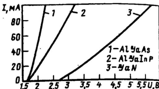
Рис. 2. Вольт-амперные характеристики светодиодов
