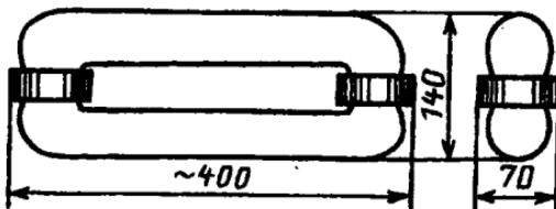
Рис. 7. Общий вид и габариты БИЛ типа Endura
