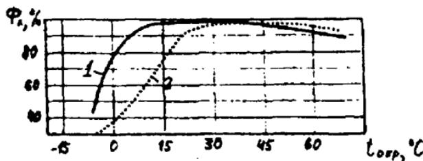
Рис. 19. Температурная зависимость светового потока 6-канальных амальгамных КЛЛ для светильников внутреннего освещения (на примере лампы Dulux T/E IN 18 Вт):
