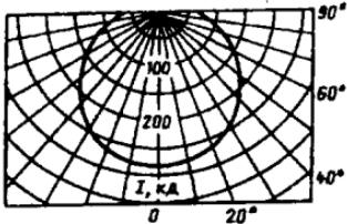
Рис. 5. Кривая силы света БИЛ типа Genura
