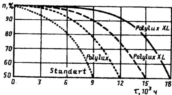
Рис. 3. Кривые выхода из строя ЛЛ диаметром 26 мм фирмы General Electric Lighting ( $n$  — доля ламп, вышедших из строя):
