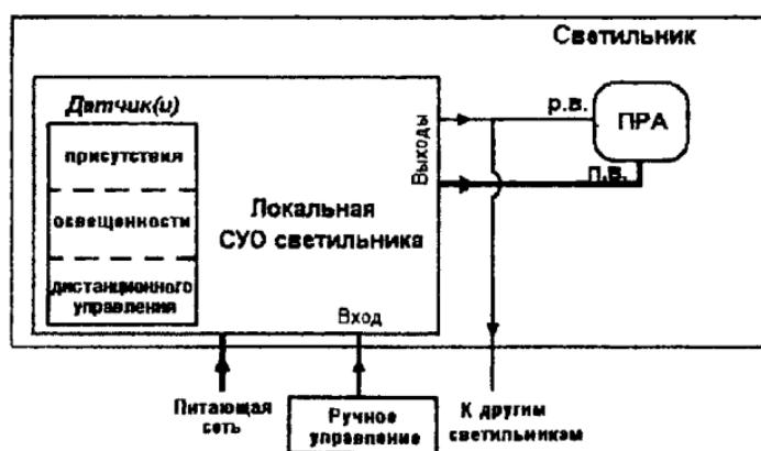
Рис. 1. Обобщенная принципиальная схема "СУО светильника":
