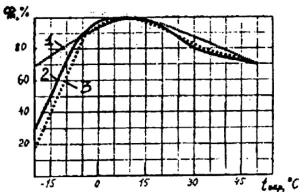
Рис. 22. Температурная зависимость светового потока специальных КЛЛ для светильников наружного освещения:
