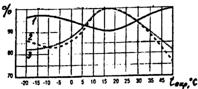
Рис. 24. Зависимость электрических характеристик (1 —  $I_{\text{л}}$ , 2 —  $U_{\text{л}}$ , 3 —  $P_{\text{л}}$ ) от окружающей температуры для КЛЛ с выносным ЭПРА (данные фирмы Osram)
