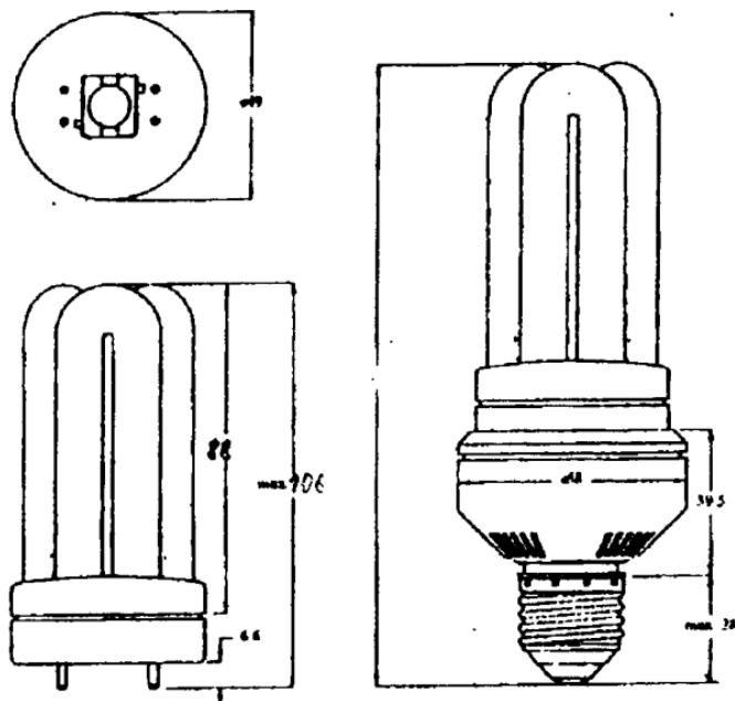
Рис. 32. Разъемная шестиканальная КЛЛ из серии ТВХ мощностью 15 Вт с адаптером:
