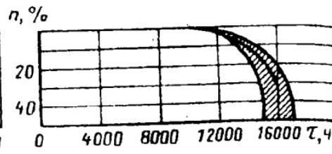
Рис. 5. Средний срок службы ЛЛ диаметром 16 мм (серия TL'5 HE, Philips Lighting),  $n$  — доля ламп, вышедших из строя
