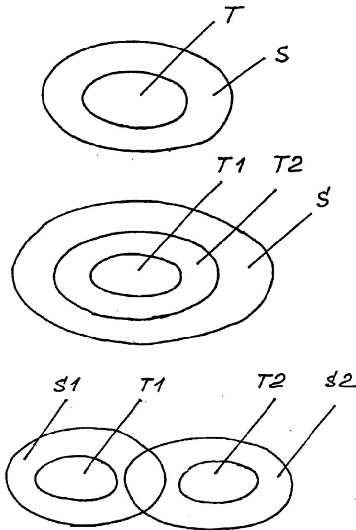
Рис. 1. Примеры расположения рабочих зон ( $T$ ) и зон окружения ( $S$ )
