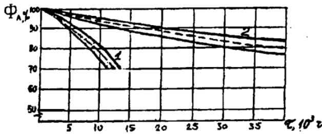
Рис. 1. Зависимость светового потока ЛЛ диаметром 26 мм от времени наработки:
