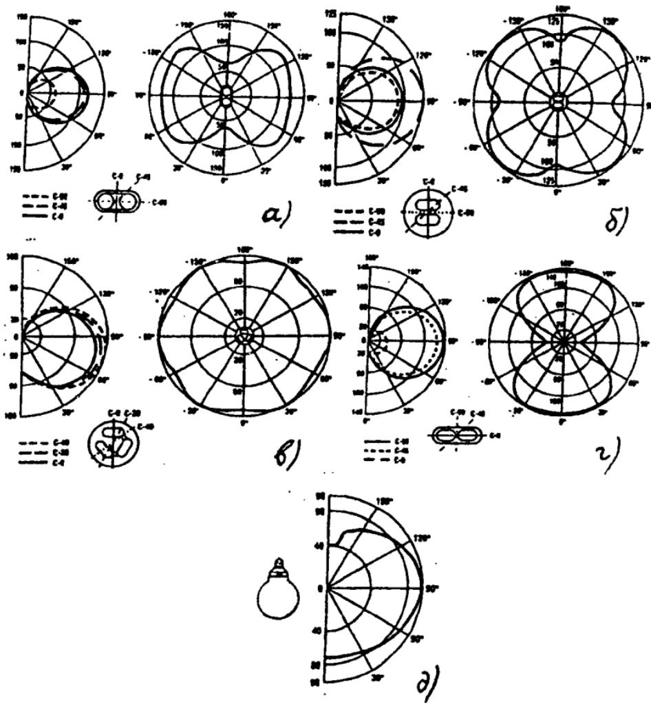
Рис. 4. Характерные КСС (в канделях на 1000 лм) в продольных (слева) и в поперечной (справа) плоскостях для КЛЛ типового ассортимента с различным числом и расположением разрядных каналов:
