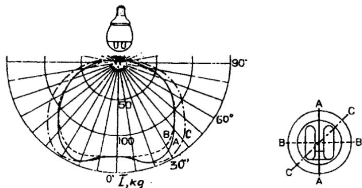
Рис. 38. Кривые силы света зеркальных КЛЛ серии EFG 15E Panasonic мощностью 15 Вт (фирма Matsushita, Япония)
