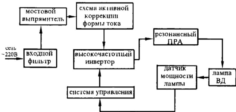
Рис. 2. Структурная схема электронного ПРА для ламп высокого давления
