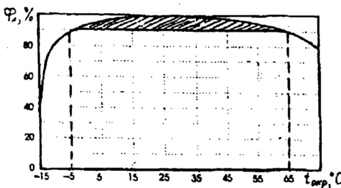
Рис. 20. Температурная зависимость светового потока 8-канальных амальгамных КЛЛ Biах в положении “цоколем вверх”
