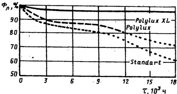
Рис. 2. Кривые спада светового потока ЛЛ диаметром 26 мм фирмы General Electric Lighting :
