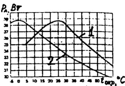
Рис. 25. Зависимость светового потока (а), напряжения на лампе (б), рабочего тока (в) и мощности (г) от окружающей температуры  $t$  для КЛЛ типа 2D мощностью 38 Вт:
