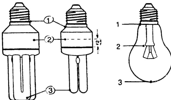
Рис. 26. Контрольные точки сравнительных измерений температуры на поверхности 6- и 4-канальных КЛЛ серии Dulux E (Osram) и ЛН
