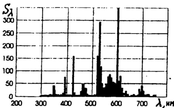
Рис. 5. Относительная интенсивность распределения энергии излучения КЛЛ с  $T_{\text{ц}} = 2700$  К в видимой области спектра (мВт/5 нм/кдм)
