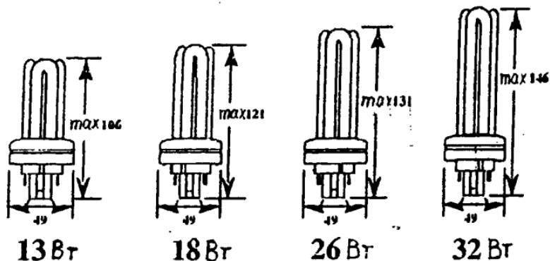
Рис. 29. Габариты амальгамных КЛЛ фирмы GE-Lighting, включаемых с выносными ПРА (серия Biax T/E)
