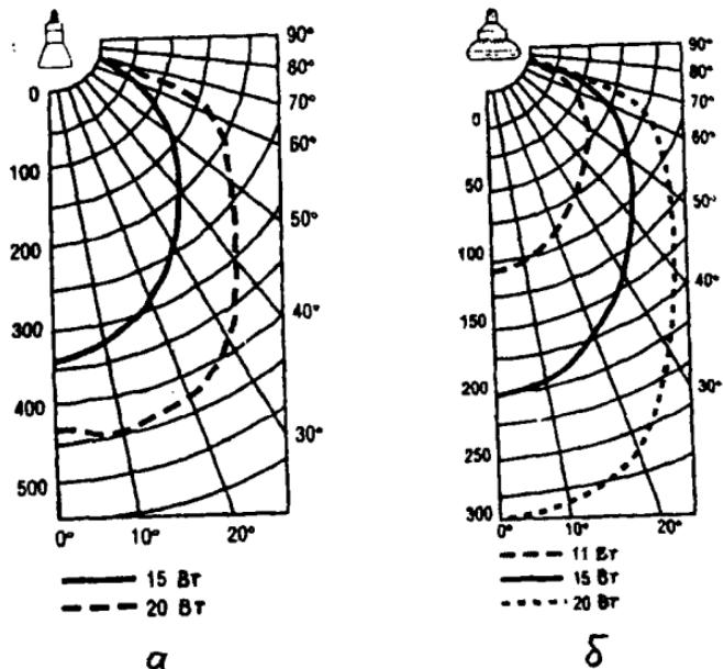
Рис. 37. Кривые силы света (кд) КЛЛ с направленным излучением (фирма Osram):
