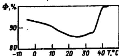
Рис. 2. Зависимость светового потока БИЛ типа QL от температуры окружающего воздуха
