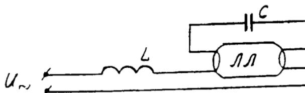
Рис. 3. Резонансная схема зажигания
