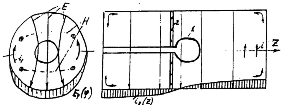
Рис. 4. Структуры СВЧ-полей и токов для  $TE_{11}$  вида колебаний в цилиндрическом резонаторе
