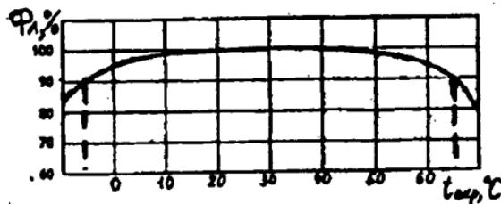
Рис. 21. Температурная зависимость светового потока новой амальгамной КЛЛ 55 Вт из серии 2D (GE-Lighting)
