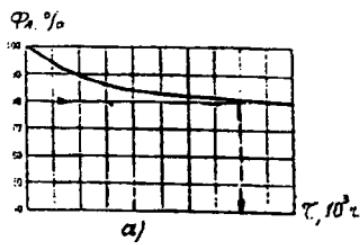
Рис. 7. Полезный срок службы КЛЛ типов ТС, ТС-Д, ТС-Т при включении с ЭмПРА:
