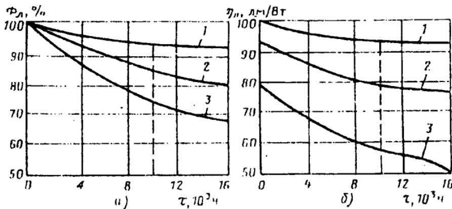
Рис. 1. Кривые спада светового потока (а) и световой отдачи (б) в течение срока службы:
