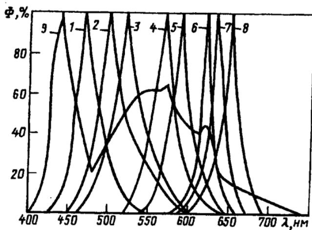
Рис. 4. Спектральное распределение энергии излучения светодиодов:
